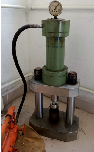
Şekil 4 : Toz numuneleri pellet haline getirmek için yüksek basınç sağlayan hidrolik pres.
