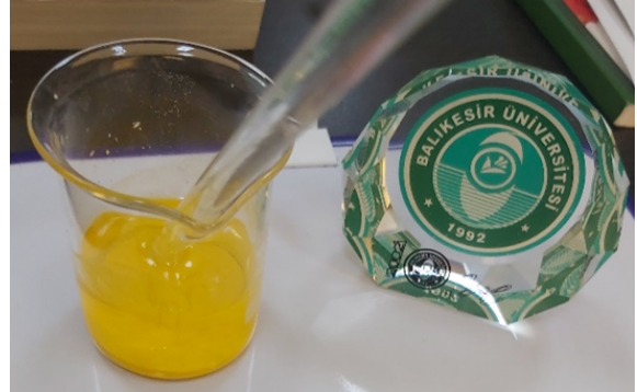
Şekil 4 : Reaksiyon sonrası beher içindeki parlak sarı renkli PbI 2 çöktürmesi.
