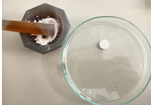
Şekil 5 : Agat havan içindeki ince toz halindeki NaHCO 3 ın pellet haline gelmiş şekli petri kabında görülmektedir.
