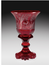
Şekil 2 : Cam - kolloidal altın karışımı (Ruby Glass).
