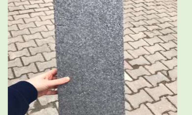
Şekil 7: EPS köpük, dış cephelerin ısı yalıtımında kullanılır.
